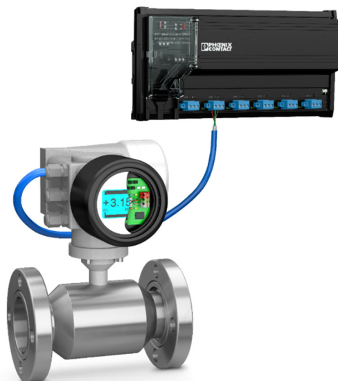
Exemplo de aplicação de sistemas com padrão Ethernet APL, com circuitos em Ethernet a dois fios, intrinsecamente seguros (2-WISE), utilizados em atmosferas explosivas. Switch de Campo 2-WISE ( Field Switch ) conectado a um instrumento transmissor de campo 2-WISE, por meio de circuitos de derivação ( spurs ). Fonte: Phoenix Contact
