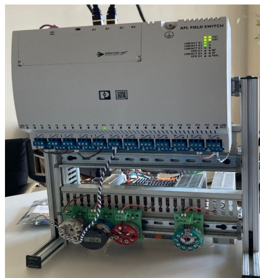
Exemplo de Switch “Ex” de campo com padrão Ethernet APL / 2-WISE. Fonte: Phoenix Contact
