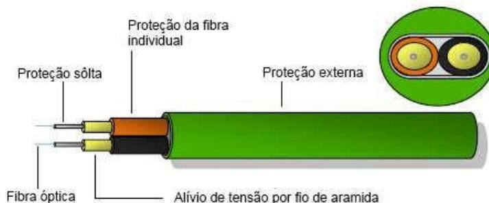
**Figura 9-6: Cabo de fibra óptica PROFINET**
