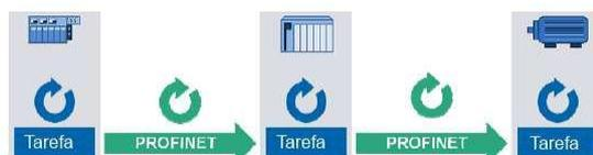
Figura 5-6: Ciclos na cadeia de processamento
