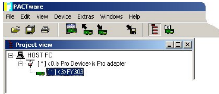
Figura 4 - Figura 3 – Topologia com DTM de comunicação e de device em um dos configuradores FDT
